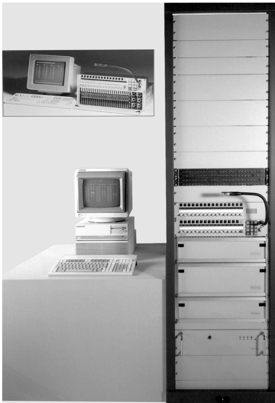
Рис. 4.4 Сопоставление интеркомовской системы 9400 с интеркомовской системы 9500 (вставка). Система 9500 олицетворяет собой резкое снижение физических размеров аппаратуры.
